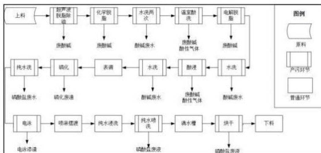
图 2.2-5 电泳工序工艺流程图
